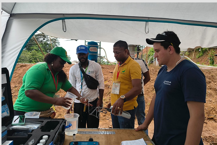
Pruebas de clorificación y calidad de agua producida por la planta de tratamiento y agua potable en Nóvita. (Agosto, 2026)
