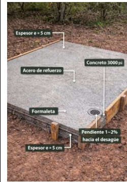
Placa en Concreto 2m x 6.9m
