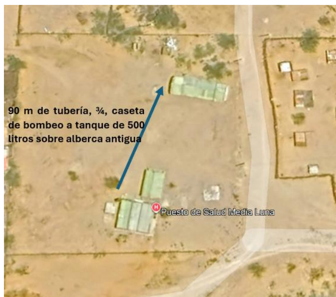
Ilustración 5. Trazado de bombeo de agua hasta tanque de 500 litros sobre alberca existente.
